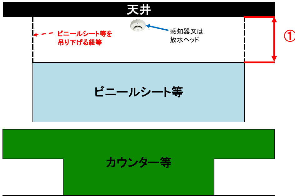
ビニールシート等の適切な設置例(正面からのイメージ)
