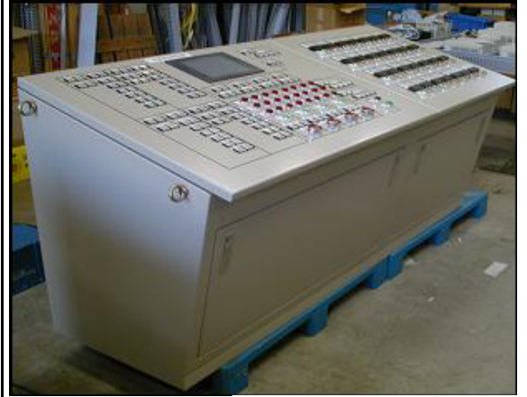
鋼管搬送ライン操作盤
