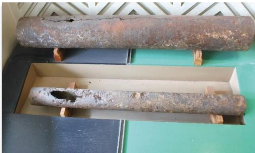
写真7-6 老朽化した水道管
