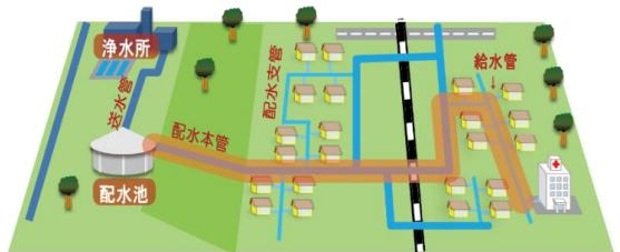
図6-1 重要給水施設への耐震化イメージ図
