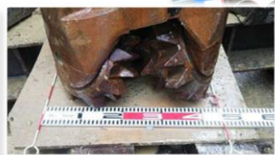
重機に取り付ける 井戸掘削用のアタッチメント
