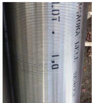
地下水を取水する部分 (スクリーン)
