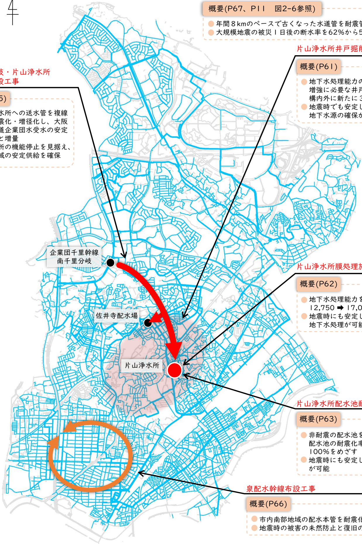
図7-6 施設整備計画の主な工事
