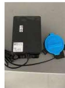
使用水量5Lごとに水道メーターからパルスが出力されるため、そのパルスを計測、パルスの回数分の水量を無線機側で積算していくことで指針値を計算する
