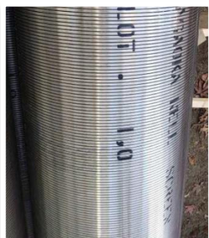
地下水を取水する部分 (スクリーン)
