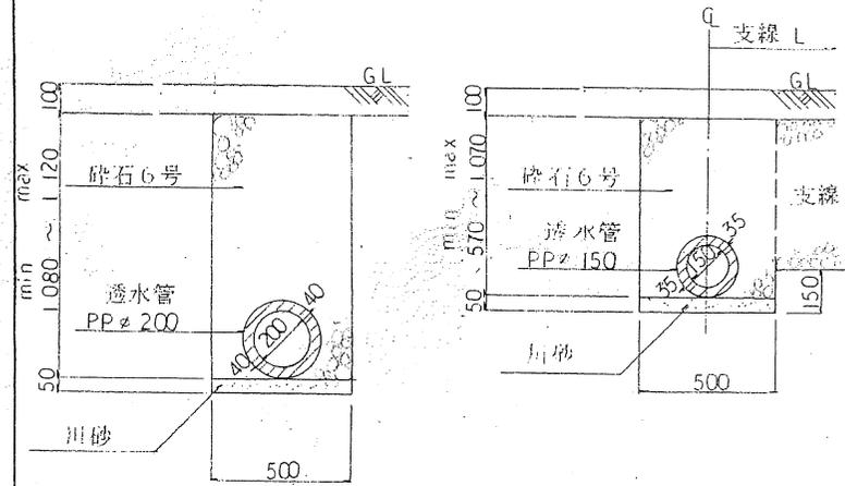
暗渠支線断面図 S=1:20 流末排水パイプ断面図 S=1:20
