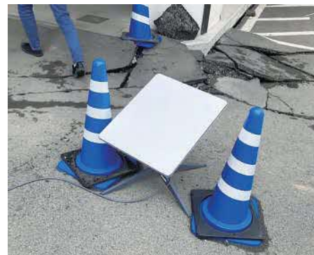
被災地での通信網の整備・強化が期待される 衛星通信機器「スターリンク」のアンテナ
