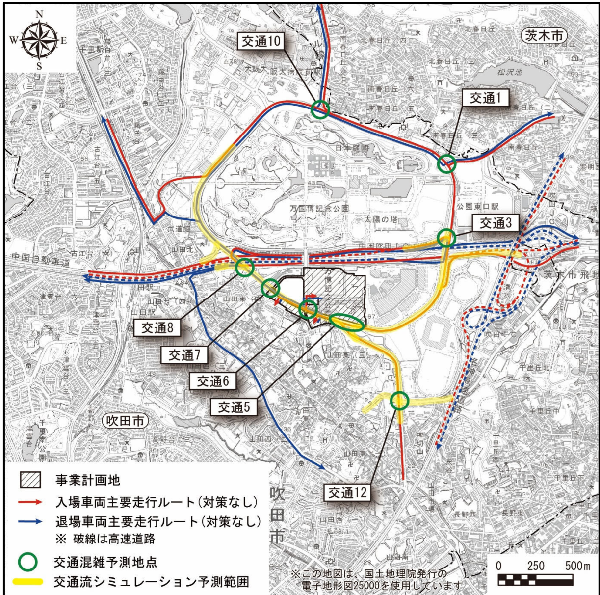
図 12 交通混雑予測地点（供用時）及び交通流シミュレーションの予測範囲
