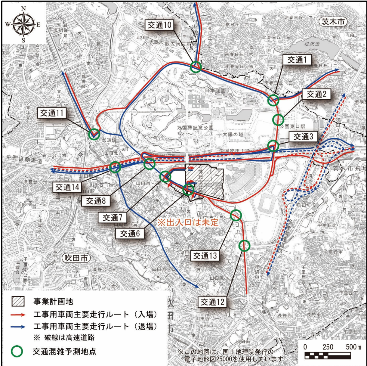
図 11 交通混雑予測地点（工事中）
