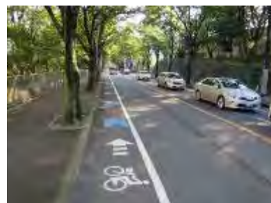
③車道混在（吹田東高校北側）
