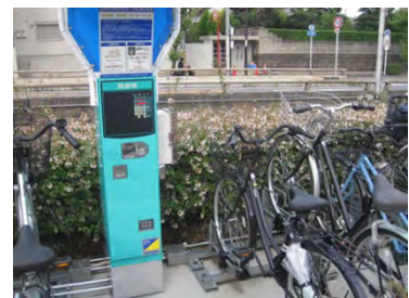
写真 5-38 電磁式ラック（吹田市）
