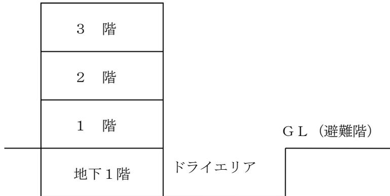
**答 1 2** ドライエリアの有効幅員が1 m以上あり、かつ、階段・スロープ等がGL (避難階) 部分の有効な通路に接続されている場合は、有効とする。
