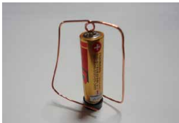
乾電池と磁石を使ったモーターの実験
