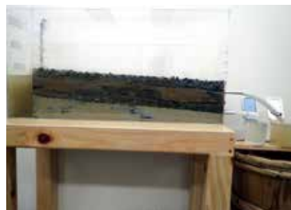
千里丘陵の地下水と湧水の仕組みの実験模型 砂礫と泥の層が交互に積み重なった地層からなる千里丘陵の湧水の仕組みを学習できる。
