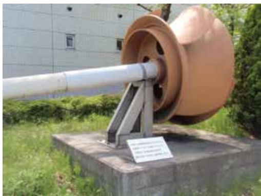
雨水排水用2000ミリポンプの羽根車と軸 1分間に612㎡の排水能力がある
