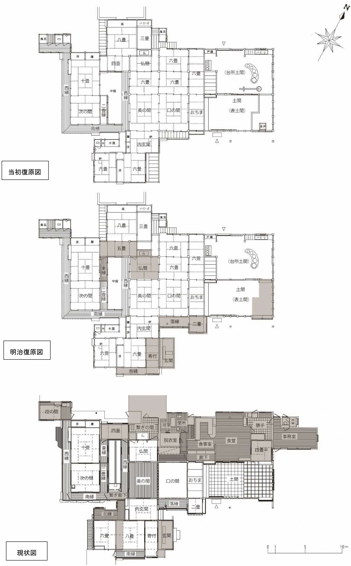
図 1-3-2-13 母屋の変遷 (着色部は変更部分)
