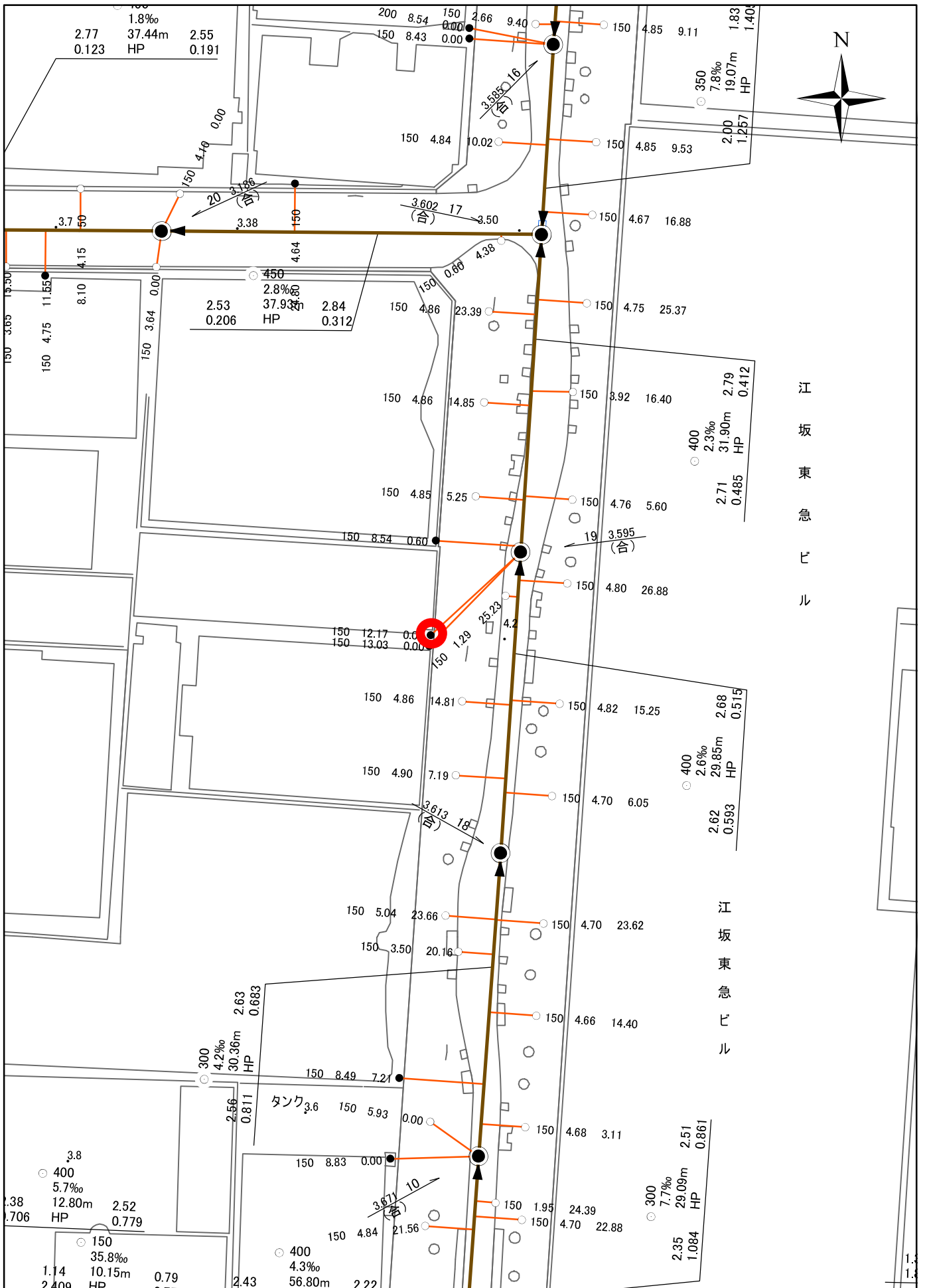
油脂閉塞予防点検箇所
