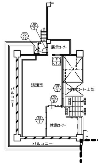
M-2階建具配置図【改修後】
