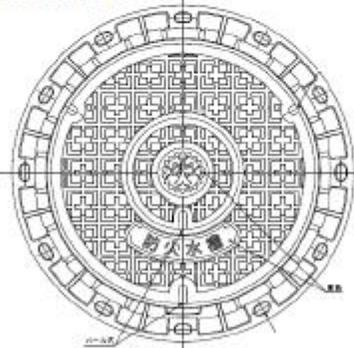
蓋の構造、形状及び寸法は、財団法人日本消防設備安全センター発行の「防火水槽等用鉄蓋性能評定実施細目」及び「防火水槽等用鉄蓋技術ガイドライン」に基づく、財団法人日本消防設備安全センターの性能評定合格品又は同等品であること。
