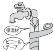
厚手の布や保温チューブなどを水道管に巻きつけたり、段ボール箱をかぶせたりして、直接冷たい空気にさらさないように対策をお願いします。
