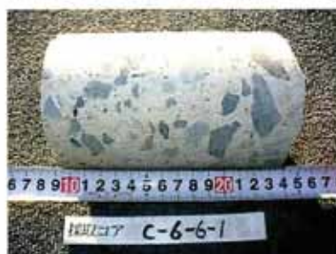
耐震診断時のコンクリートコア採取の様子
