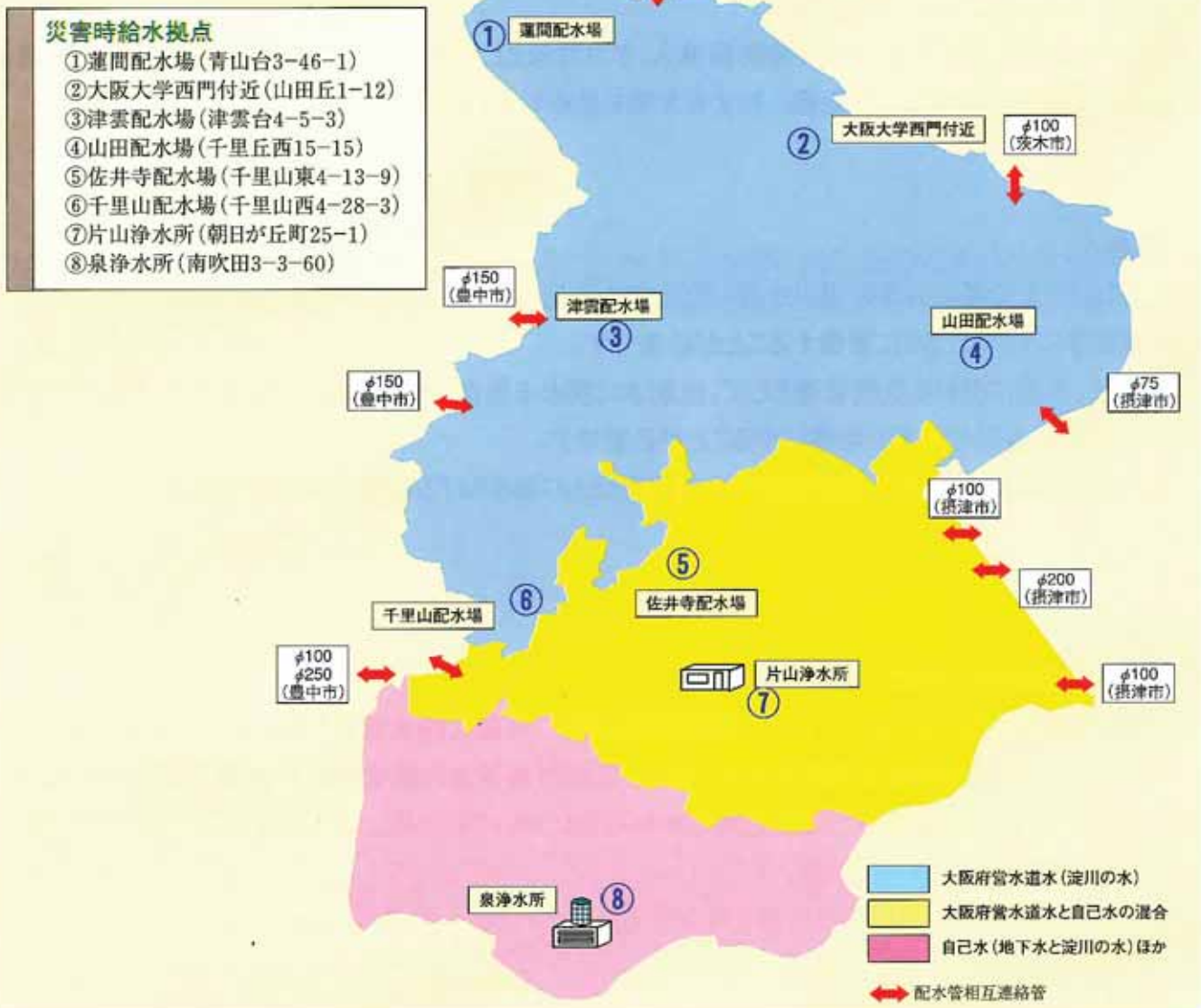
災害時給水拠点、緊急連絡管位置図
