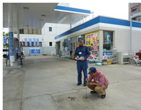
地下のタンクからガソリンがもれていないか検査している様子
