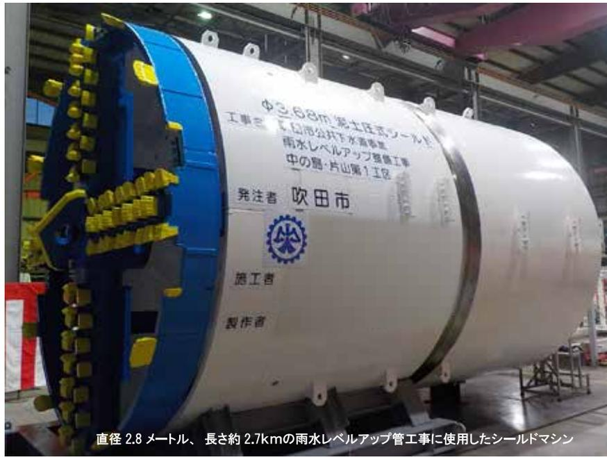
直径 2.8 メートル、長さ約 2.7kmの雨水レベルアップ管工事に使用したシールドマシン
