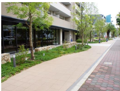
歩道と一体的な通路を設けて、広がりのある歩行者空間を確保している例
