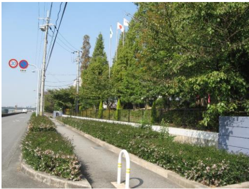
塀を道路境界から後退させて、前面に植栽帯を設置している例
