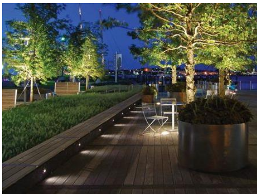
利用者や付近を通行する人の視野に直接光源が入らないようにベンチ下部の間接光でライトアップしている例
