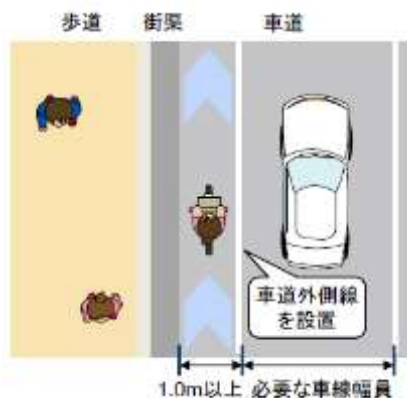
図 2-10 車道混在における車道外側線の設置
