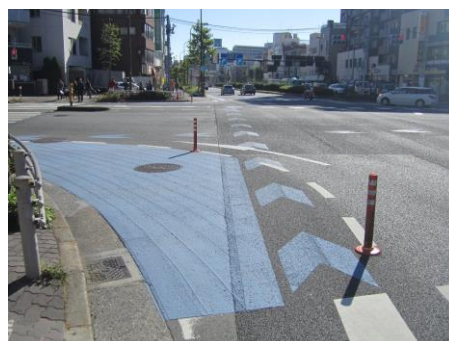
左折巻き込み防止の例(東京都文京区)
