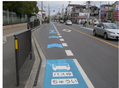
バスベイ型バス停において矢羽根を直線的に設置している例(枚方市)
