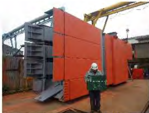
オープンシールド機：全景(シールド機前方より)
