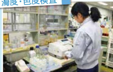
法律に基づき、毎月1回市内10か所のじゃ口(管末給水栓)から採水し、検査しています。
