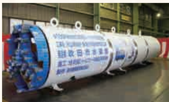
写真7-1 シールドマシン 外径φ1,594mm
