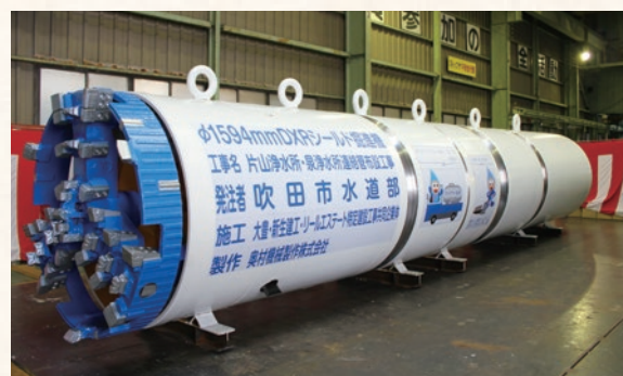
写真7-1 シールドマシン 外径φ1,594mm
