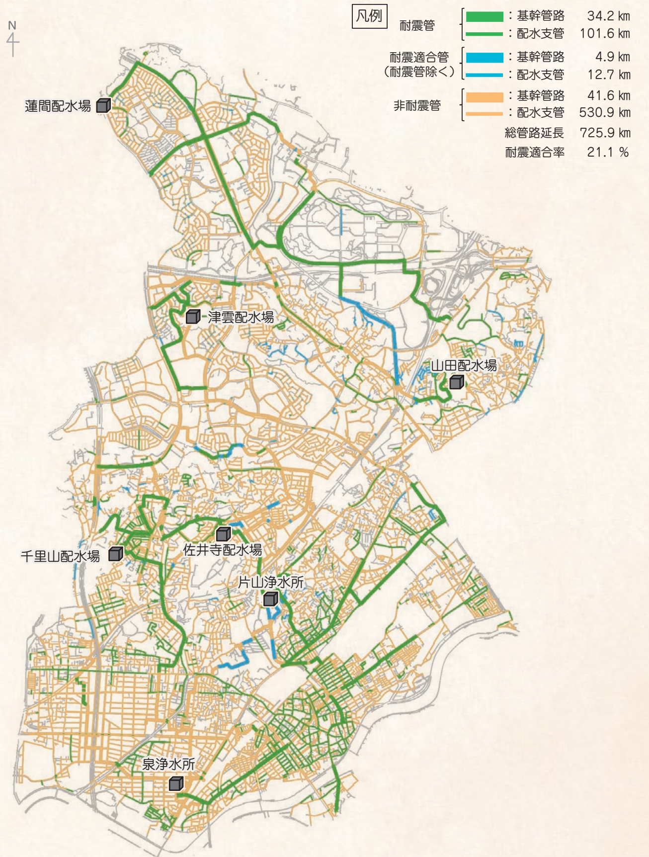
図2-7 耐震適合管路状況図
