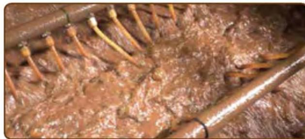
膜濃縮装置で鉄分・マンガン分が10倍に濃縮されます。
