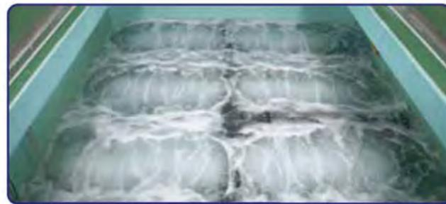
膜がつかないように空気力でモジュール表面の汚れを落とされています。
