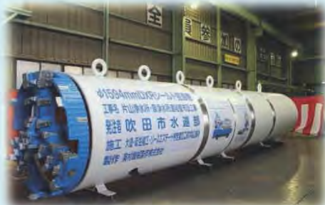
工事に使用した 穴を掘るためのシールドマシン
