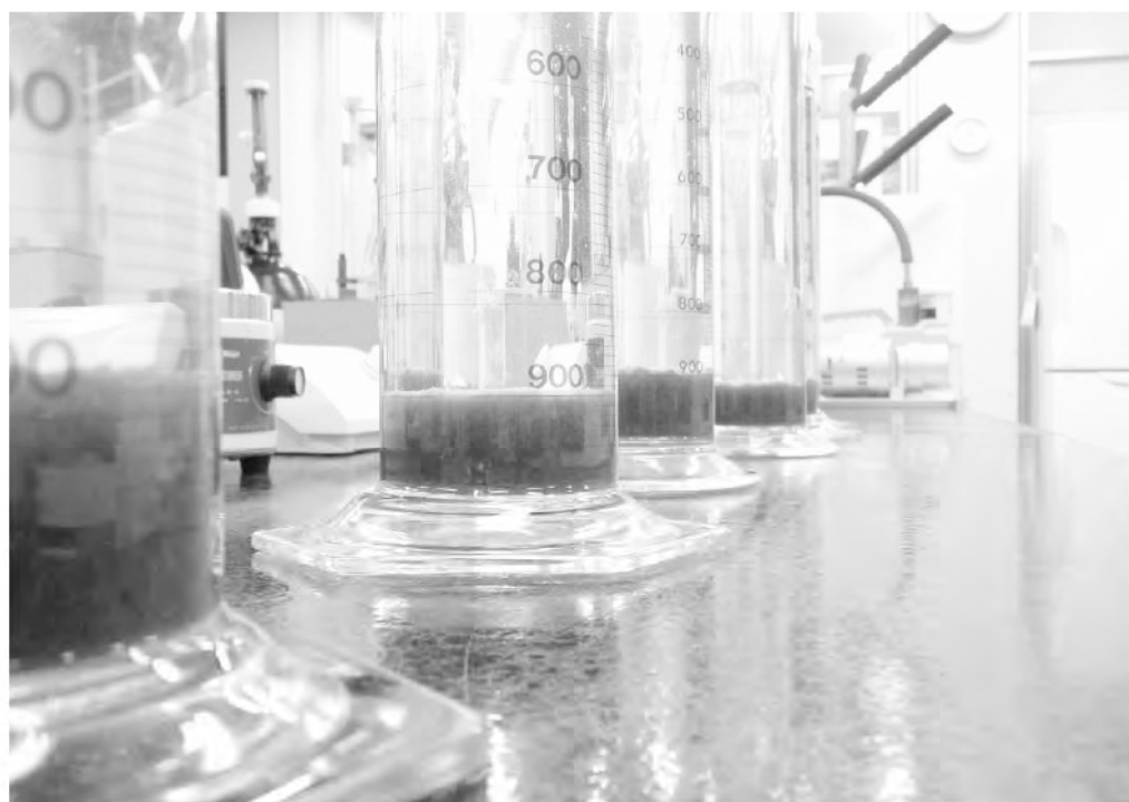
毎日行われている反応槽の汚泥試験
