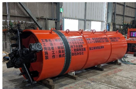
【春日雨水管路整備工事】推進マシン
