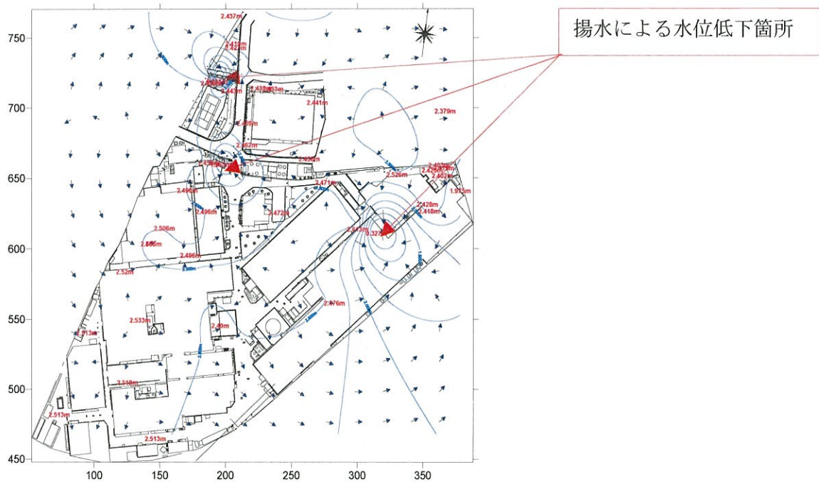
図 1-3 地下水流向（揚水稼動時）
