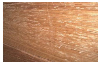
写真 7-1 白樺による塗膜の劣化
