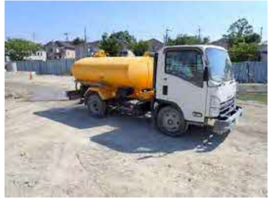
6 散水作業状況
