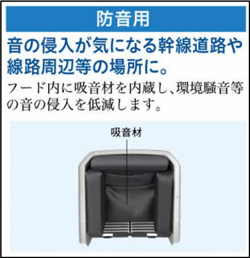
図 8-4 防音フードの構造
