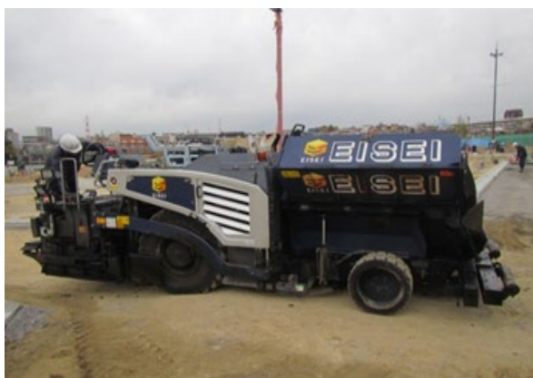
アスファルトフィニッシャ (W=2.4～4.5m)
