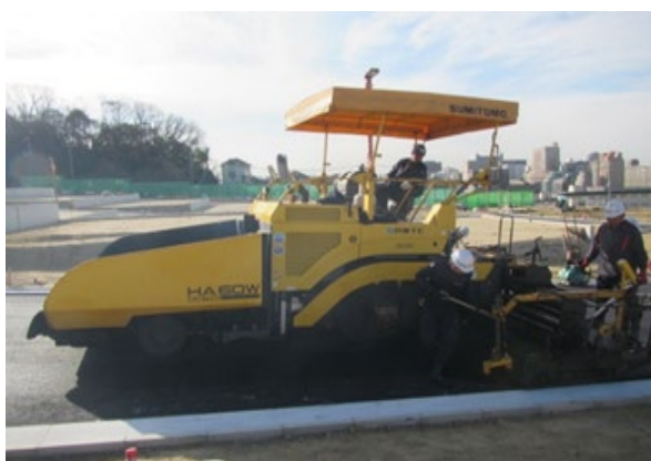
アスファルトフィニッシャ (W=2.4～6.0m)
