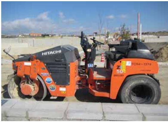
コンパインドローラ(振動ローラ、4.0t 級)
