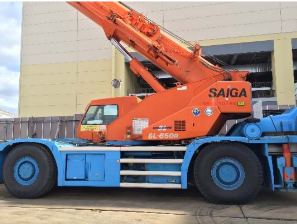
ラフタークレーン (65 t 級)
