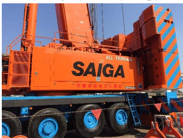
オールテレーンクレーン (550 t 級)
