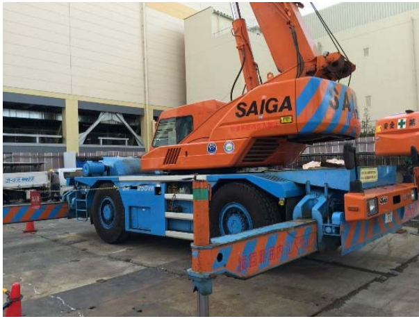
ラフタークレーン (25 t 級)
