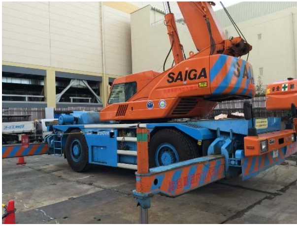
ラフタークレーン (25 t 級)
