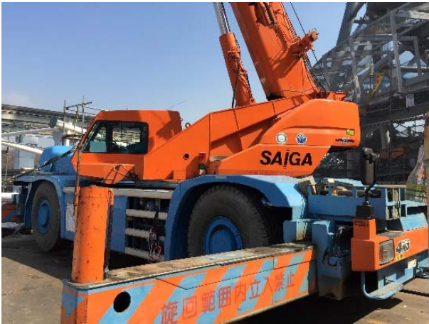
ラフタークレーン (50 t 級)
