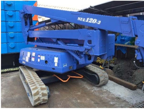
高所作業車（12m級）
