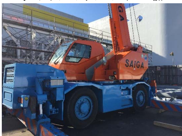
ラフタークレーン (16 t 級)
