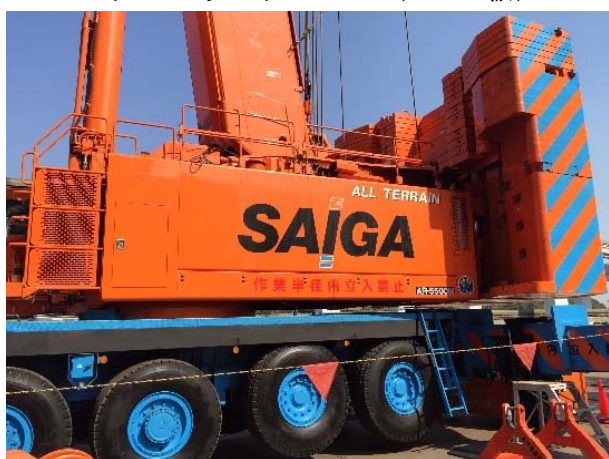
オールテレーンクレーン (550 t 級)
