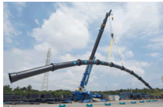
耐震管（ダクタイル鋳鉄） ※（出典）日本ダクタイル鋳鉄管協会HPより
