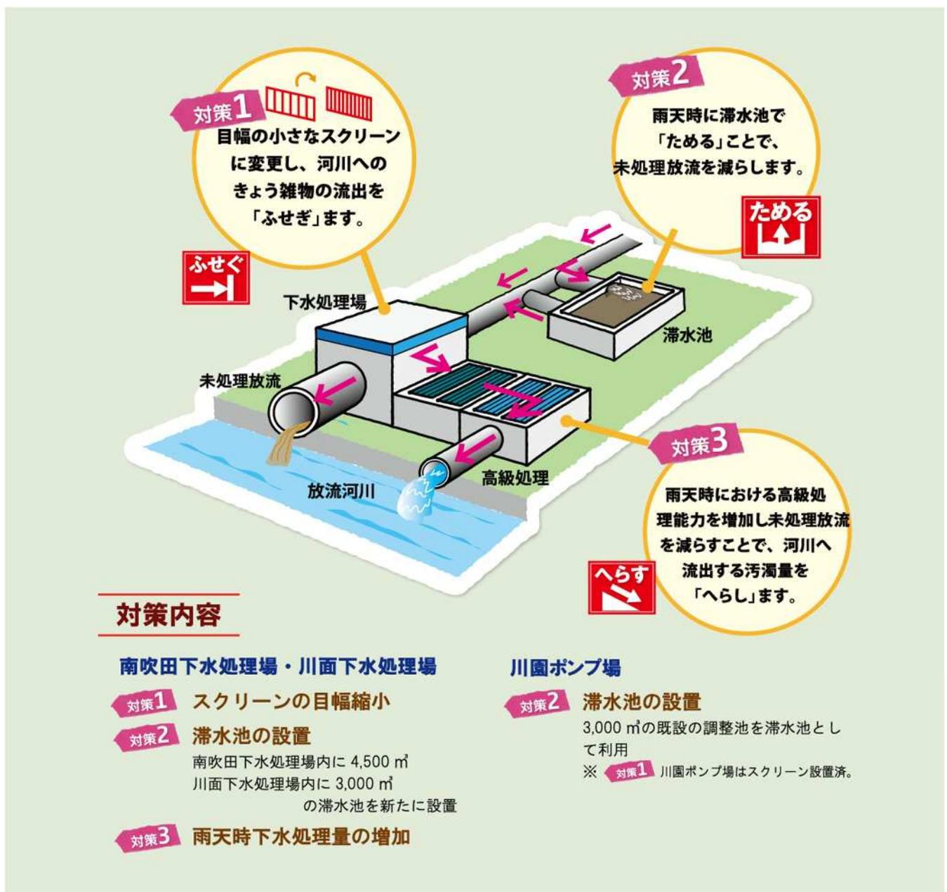
図 2.8 「合流式下水道緊急改善計画」の対策内容
