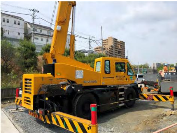
ラフタークレーン (25t)
