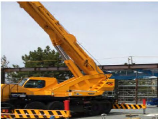
ラフタークレーン (70t)
